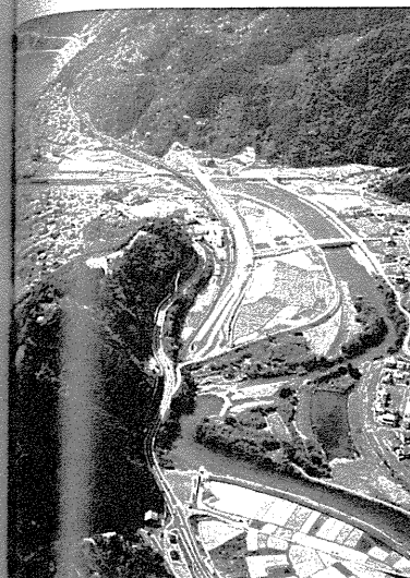
佐賀改良の現況。写真上部に見える横浜トンネルは、全長624mのほぼ90%まで掘り進んでいる。一部供用開始(L=300m)
