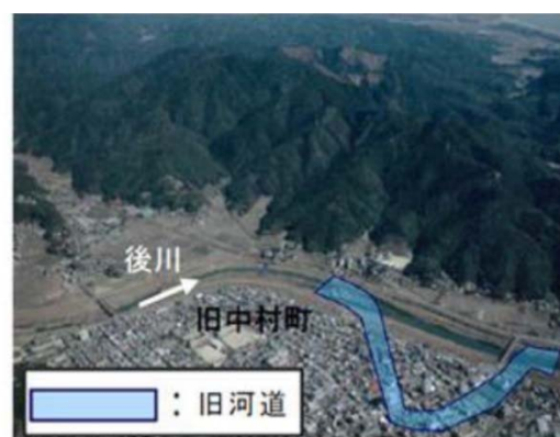
後川は、水色で描かれた流れから写真の流れに、真っ直ぐに付替られました。
