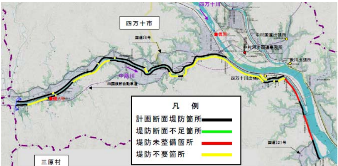
図18 中筋川堤防の整備の状況図
