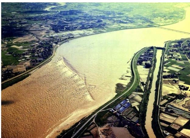
写真 31 昭和 49 年洪水時のせき上げ現象
